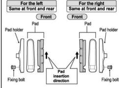
4. Tighten the fixing bolt.
